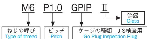
メートルねじプラグゲージ (ISO方式) Metric Thread Plug Gauge (ISO method)
