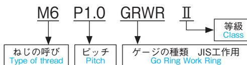
メートルねじリングゲージ (ISO方式) Metric Thread Ring Gauge (ISO method)
